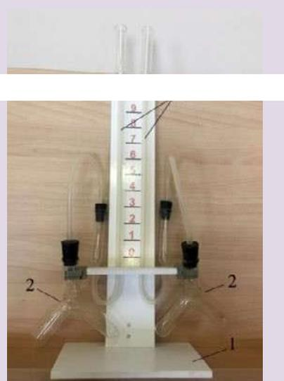
соединяются с сосудами Ландольта с помощью пластиковой трубки и пробками (рис. 5). Между манометрическими трубками на панели нанесена шкала для наблюдения уровня жидкости в трубках. Окрашенной жидкостью может быть раствор любого красителя в воде.
