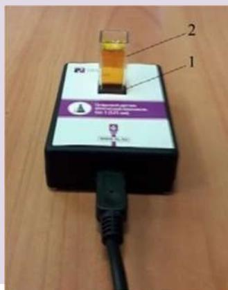
**Цифровая (компьютерная) лаборатория (ЦЛ)**, программно-аппаратный комплекс, датчиковая система — комплект учебного оборудования, включающий измерительный блок, интерфейс которого позволяет обеспечивать связь персональным компьютером, и набор датчиков<sup>1</sup>, регистрирующих значения различных физических величин.
